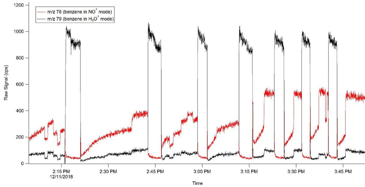
**Figure 2-2. Benzene in Both NO<sup>+</sup> and H<sub>3</sub>O<sup>+</sup> Mode While Mode-Switching.**
